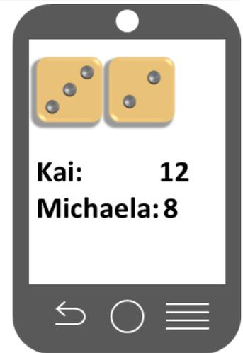
Das Beispiel beinhaltet ein äußeres `LinearLayout`, welches den Gesamtrahmen bildet. Dies ist vertikal ausgerichtet, da es zuerst die beiden Würfel und anschließend die Tabelleninformation abbilden muss. Als erstes Kindelement fungiert ein weiteres `LinearLayout`, welches die beiden Würfel positioniert. Anschließend wird
